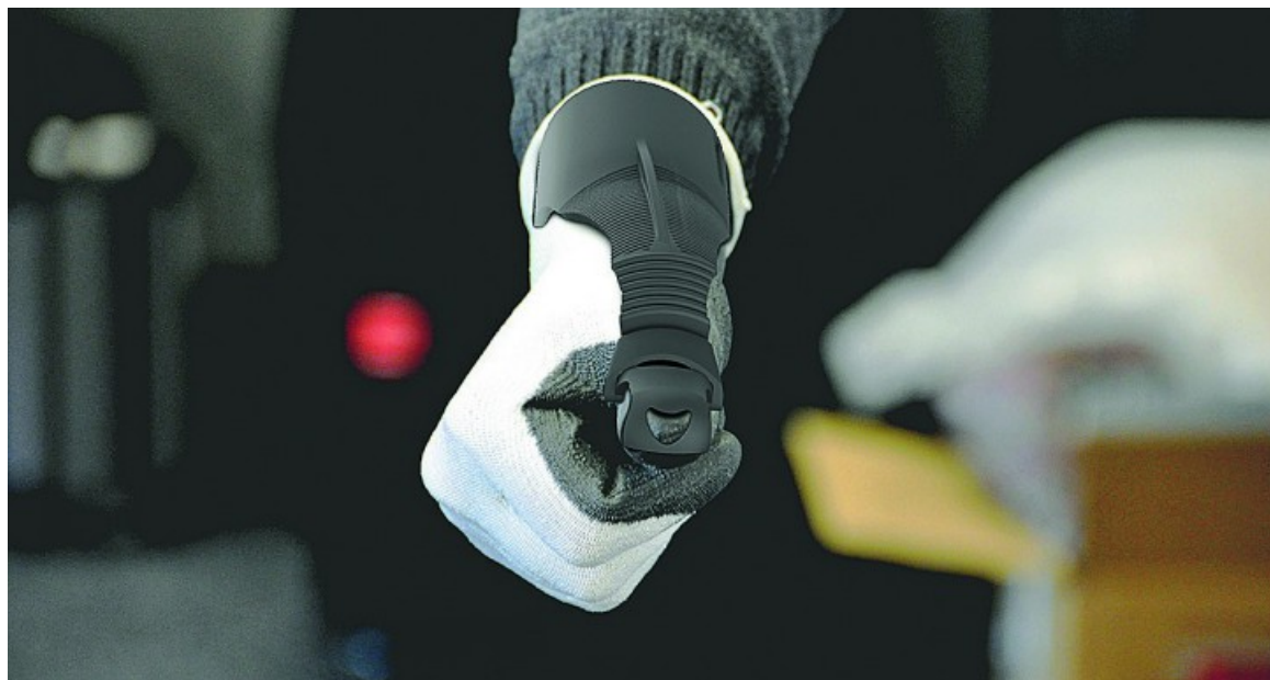
Exoesqueleto para el pulgar desarrollado por el grupo Iturri junto al Fraunhofer alemán.
